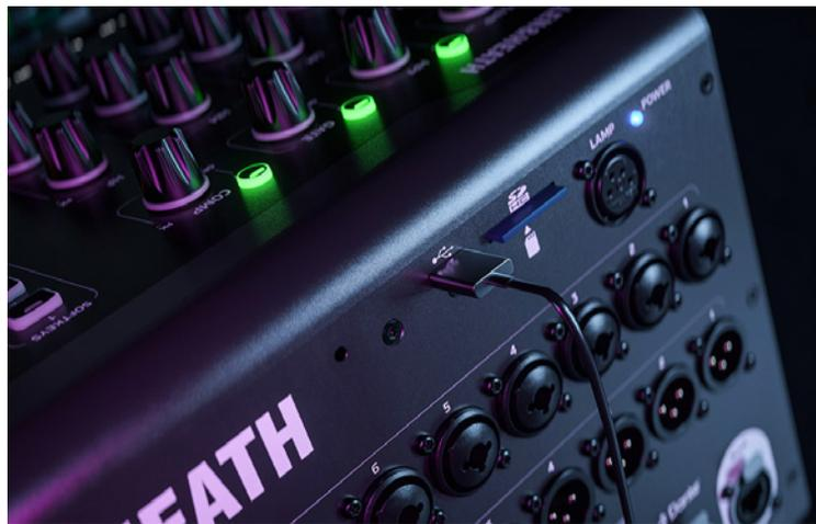
全新 Qu96 的录音和回放功能更是让人拍案叫绝。通过 USB-A、USB-C 接口以及 SD 卡插槽，Qu96 系列支持立体声和多通道音频的录制与回放。特别是 SD 卡，可支持 16×16@96kHz 或 32×32@48kHz 的多轨录音，这意味着你在现场演出、录音棚等场景下，能迅速捕捉并保存每一个高品质音频瞬间，方便后续的精修和回顾，大大地提升了工作效率，让录音工作不再繁琐复杂，而是变得轻松又专业。
